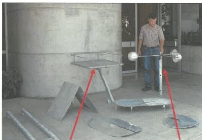
Figure 24 : Plateforme et anémomètre (RTE)
